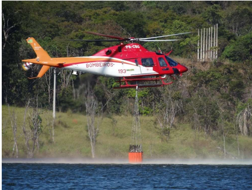
Figura 36 – Captação de Água Fonte: Fonte: CBMGO – COA (2017).
