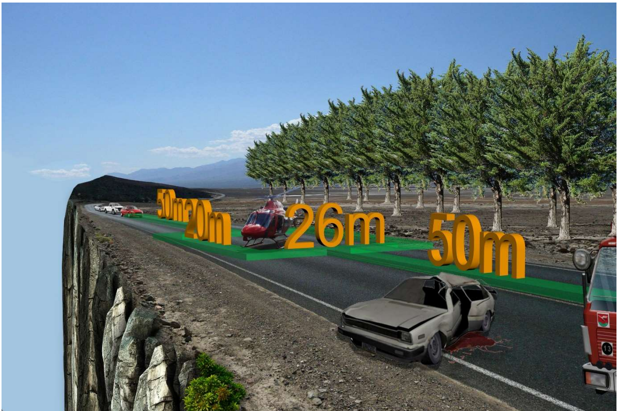
Figura 30 – Isolamento para Pouso em Rodovia Fonte: CBMGO – COA (2017).
